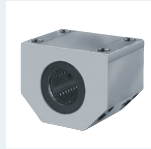
Linear-Set R1701.. geschlossen Wellendurchmesser 20–60 mm Präzisions-Gehäuse aus Aluminium (Leichtbau- weise), mit Super-Kugel- büchse H oder SH , nach- schmierbar mit zwei Dichtringen
