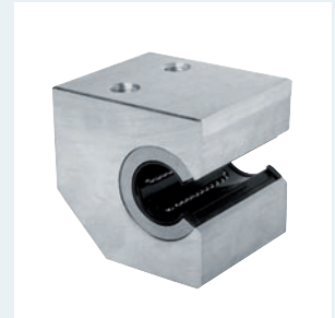
Linear-Set R1071.. seitlich offen Wellendurchmesser 20–50 mm Präzisions-Gehäuse aus Aluminium (Leichtbauweise), mit Super-Kugelbüchse A oder B , nachschmierbar mit zwei Dichtringen und Längsdichtung (komplett abgedichtet)
