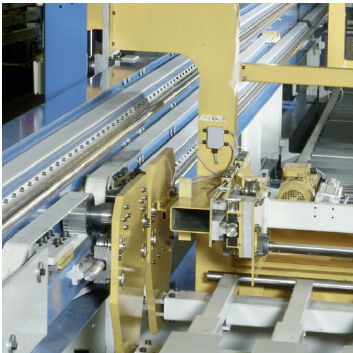
Präzisions-Stahlwelle, R0724 0, mit vier Laufbahnritzen, Hohlwelle
