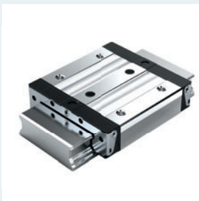
CNS Stahl, Resist CR Größen 20/40, 25/70 Für hohe Torsionsmomente auf einer Schiene bei seitlich begrenztem Bauraum, sehr hohe Tragfähigkeit, von oben verschraubbar
