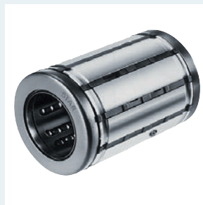
Super-Kugelbüchse SH R0730.. geschlossen, mit Fluchtungsfehlerausgleich Wellendurchmesser 20–50 mm Zusätzliche, tragende Stahl- einlagen mit geschliffenen Laufbahnritzen, ohne oder mit integrierten Dichtringen
