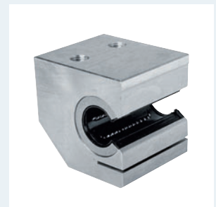
Linear-Set R1072.. seitlich offen, einstellbar Wellendurchmesser 20–50 mm Präzisions-Gehäuse aus Aluminium (Leichtbauweise), mit Super-Kugelbüchse A oder B , nachschmierbar mit zwei Dichtringen und Längsdichtung (komplett abgedichtet)
