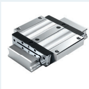
BNS Stahl, Resist CR Größen 20/40, 25/70, 35/90 Für hohe Torsionsmomente auf einer Schiene, sehr hohe Tragfähigkeit, von oben und unten verschraubbar
