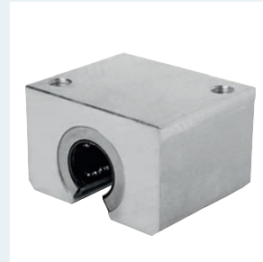
Linear-Set R1037.. offen Wellendurchmesser 12–50 mm Präzisions-Gehäuse aus Aluminium (Leichtbauweise), mit Super-Kugelbüchse A oder B , nachschmierbar
