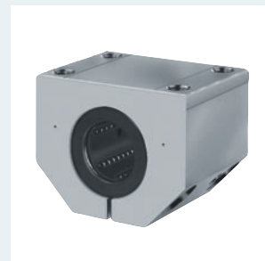
Linear-Set R1702.. geschlossen, einstellbar Wellendurchmesser 20–60 mm Präzisions-Gehäuse aus Aluminium (Leichtbau- weise), mit Super-Kugel- büchse H oder SH , nach- schmierbar mit zwei Dichtringen
