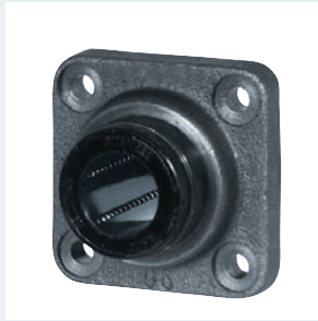
Linear-Set R1081.., Flansch Wellendurchmesser 12–50 mm, Präzisions-Flanschgehäuse aus Grauguss , zwei Super- Kugelbüchsen A oder B , integrierte Dichtringe
