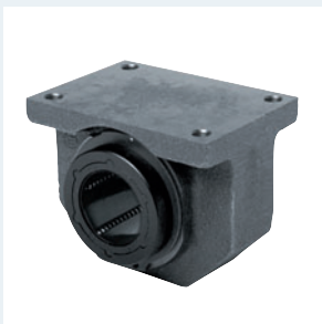
Linear-Set R1065.. geschlossen Linear-Set R1066.. geschlossen einstellbar Wellendurchmesser 12–50 mm Präzisions-Gehäuse aus Aluguss , mit Super-Kugel- büchse A oder B , inte- grierte Dichtringe
