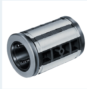
Super-Kugelbüchse R R0732.. geschlossen, mit Fluchtungsfehlerausgleich Wellendurchmesser 20–60 mm Zusätzliche Kugelreihen für höhere Tragzahlen, geschlif- fene Laufbahnritzen, ohne oder mit zwei integrierten Dichtringen
